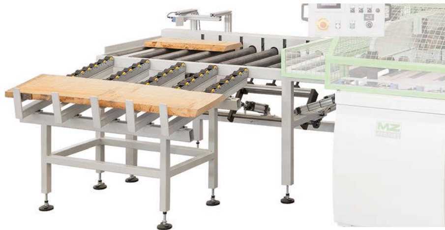
➤ Espulsore pneumatico con discese raccogli pezzi, su rulliera in uscita o su rulliera indipendente Pneumatic ejecting device on outgoing roller table or on extra outgoing roller table with collecting system of sawn parts ✓cs1000 ✓ROLLER
