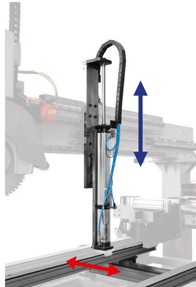
Dispositivo per il posizionamento automatico dei tavoli Device for automatic positioning of tables
