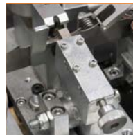
Empujadores ajustables Para trabajo preciso.
