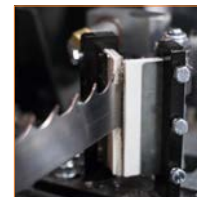
Sistema de limpiamiento de aceite.
