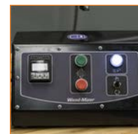
Caja de control eléctrica de alimentación Interrupción del indexador auto/manual y contador de dientes.
