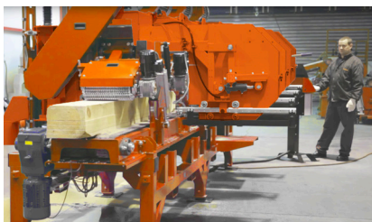
Setworks y movimiento vertical automático opcionales Aumente la productividad del operador con el Setworks electrónico y el sistema de movimiento sube y baja automático.
