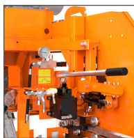
Sistema de tensión de la sierra Tensado y lubricación de las sierras centralizado para cada módulo.
