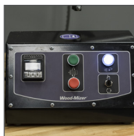
Caja de control eléctrica de alimentación Interrupción del indexador auto/manual y contador de dientes.
