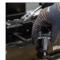
Ajuste de la sierra Un solo perno de ajuste para sierras de 25-38mm (1-1½").
